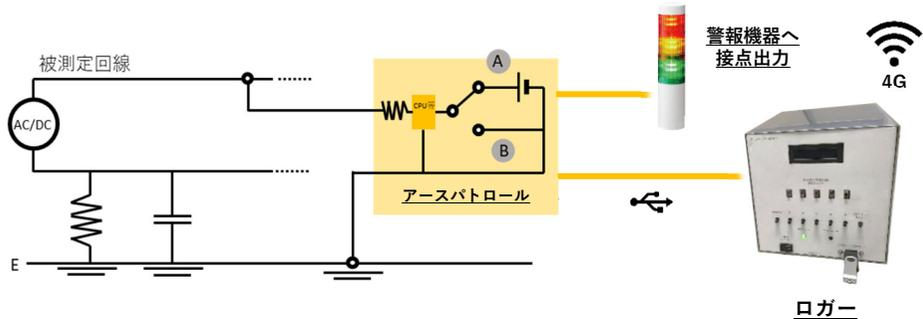
A：直流電流を印加し、「活線の電源電圧+測定電圧」条件
